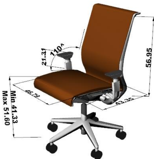
شکل ۱. شماتیک مشخصات صندلی
