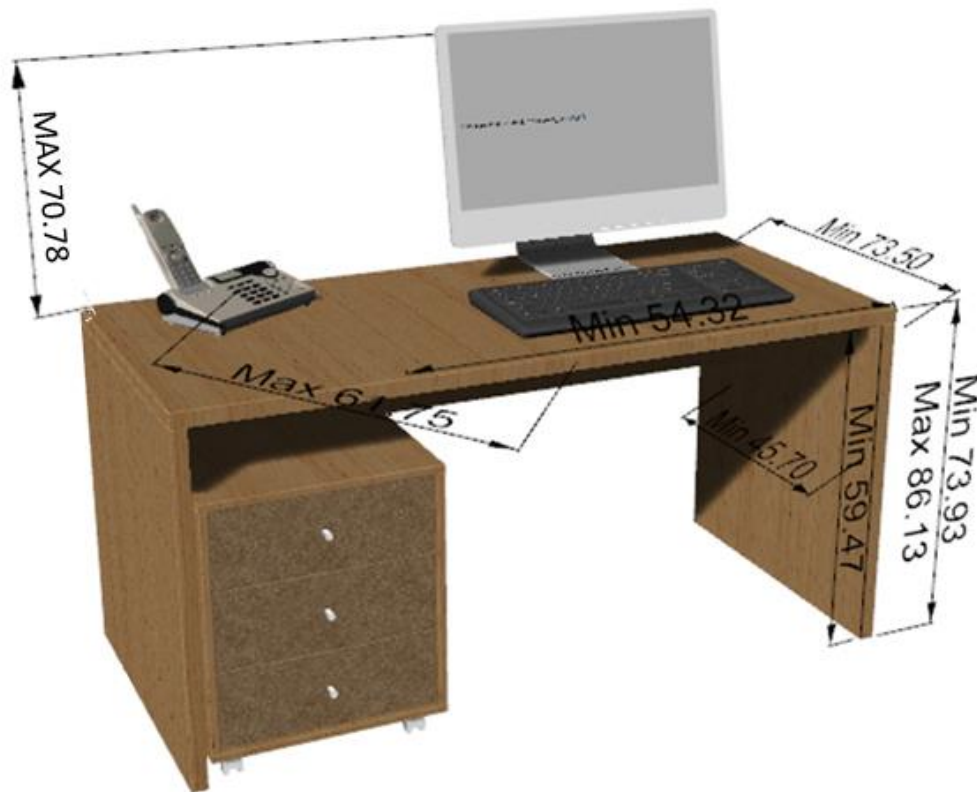
شکل ۲. شماتیک مشخصات میز کار اداری
